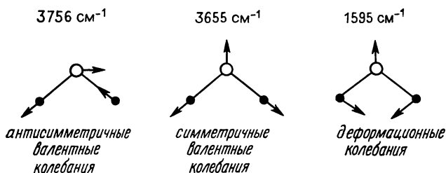
Рис. 92. Колебания молекулы воды.
