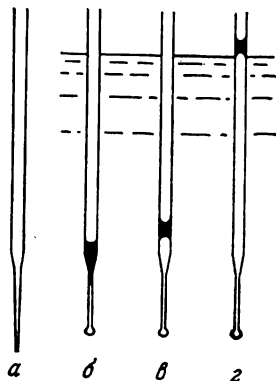
Рис. 83. Определение температуры кипения по Эмиху.
